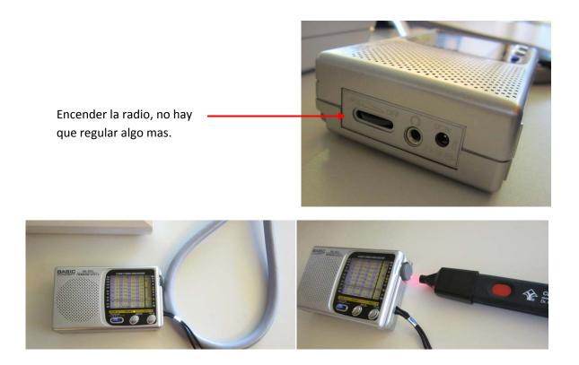
Encender el MEDISEND super y colocar la radio con la antena cerca al lado del lazo / del CEPES-Laser.
